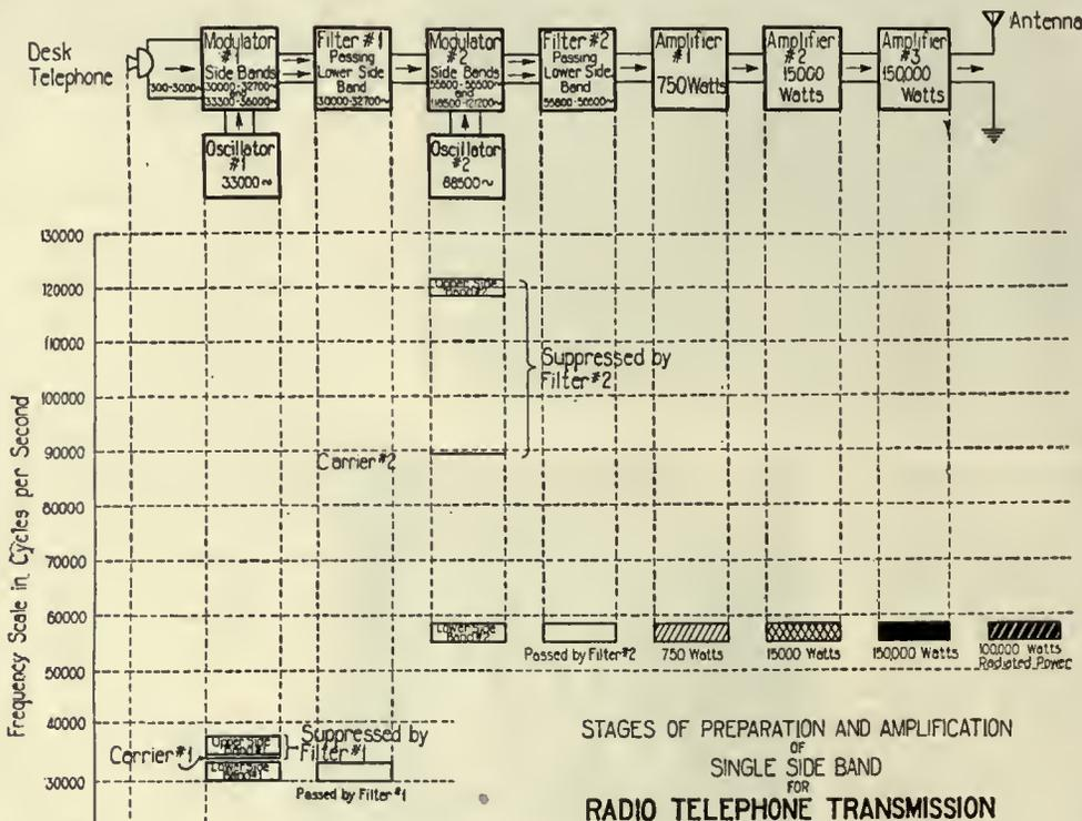
HOW THE SINGLE SIDE BAND SYSTEM WORKS
