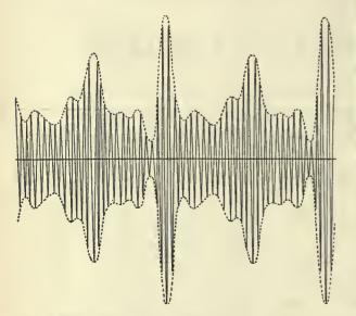
A MODULATED RADIO FREQUENCY WAVE
