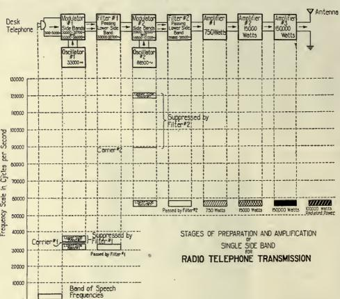
HOW THE SINGLE SIDE BAND SYSTEM WORKS
